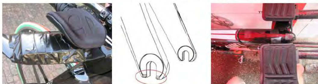
Figure 2 : Quelques exemples de modification du matériel interdit (ajout de tape, limage des ergots de fourche et recouvrement des vis du cadre et du guidon)
