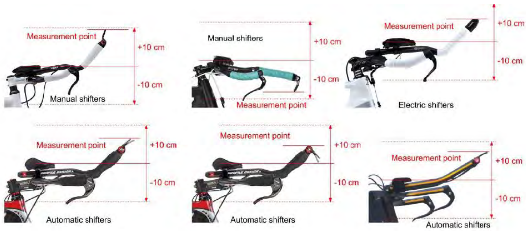
Figure 31 : Points de mesure des limites verticales des prolongateurs avec tous leurs accessoires
